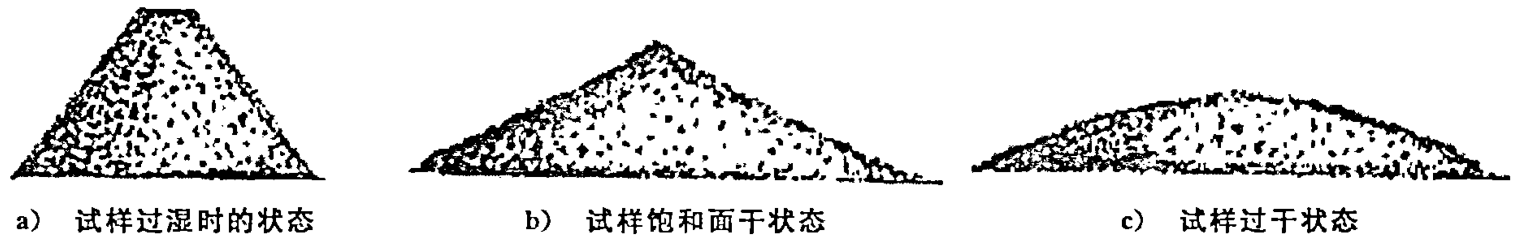
图4 天然砂饱和面干试样的状态
