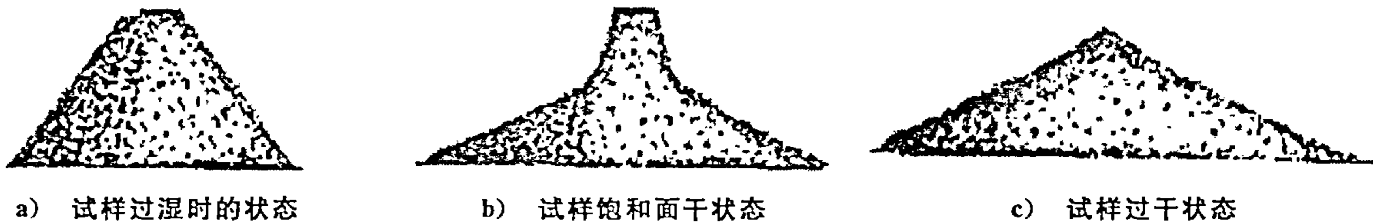
图3 机制砂饱和面干试样的状态
